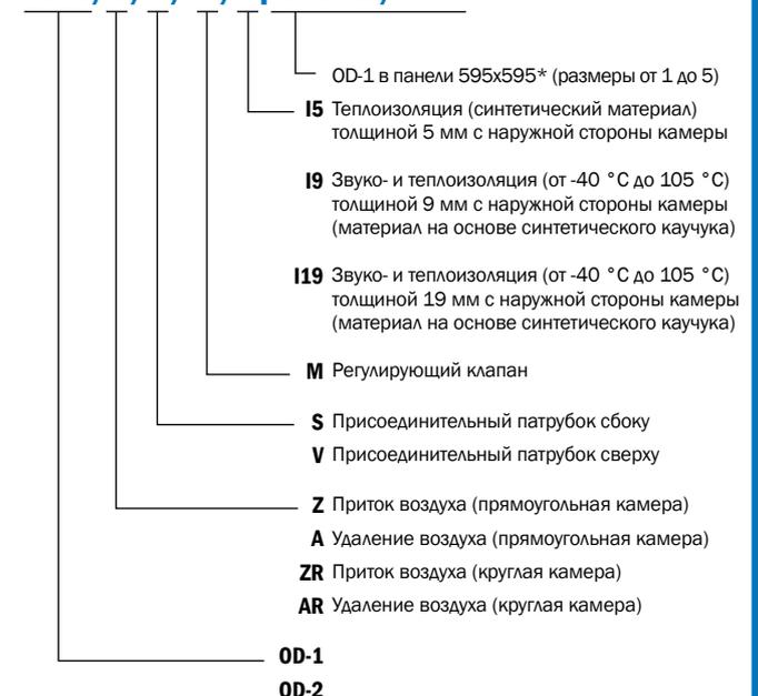
\*При установке диффузоров на соединительную камеру используется только центральное крепление.
