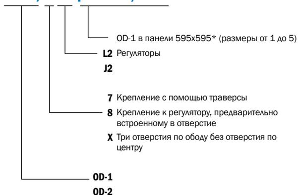
\*Крепление панельного диффузора OD-1 возможно только с помощью траверсы 7.
